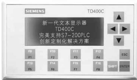
TD400C 是配 S7-200CN 最佳的中文文本显示器。TD400C 连接很简单，只需用它提供的连接电缆接到 CPU 22X CN 系列 PPI 接口上即可。
